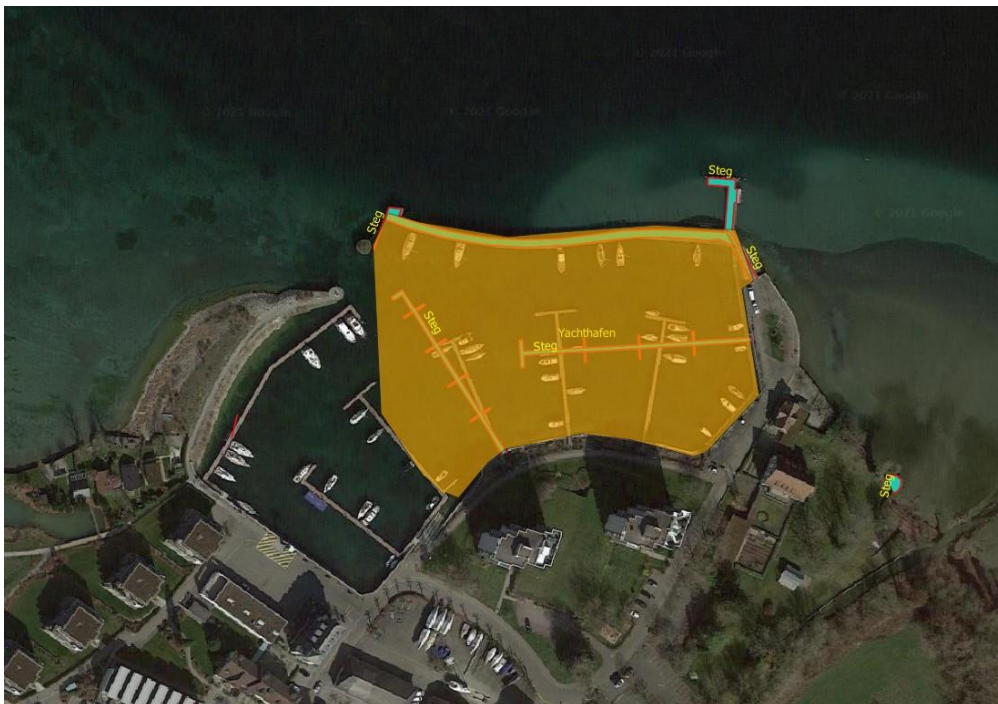
Abbildung 5: Zeitliche Veränderung zwischen der Kartierung und dem aktuellen Zustand: Hafenumbau und -erweiterung in Bottighofen. Orange, blau - Erfassung durch TEIBER (2002). Zu erkennen sind die Erweiterung des Hafenbeckens nach Westen sowie eine Neugestaltung der Stege. Hintergrund: Google Earth.
