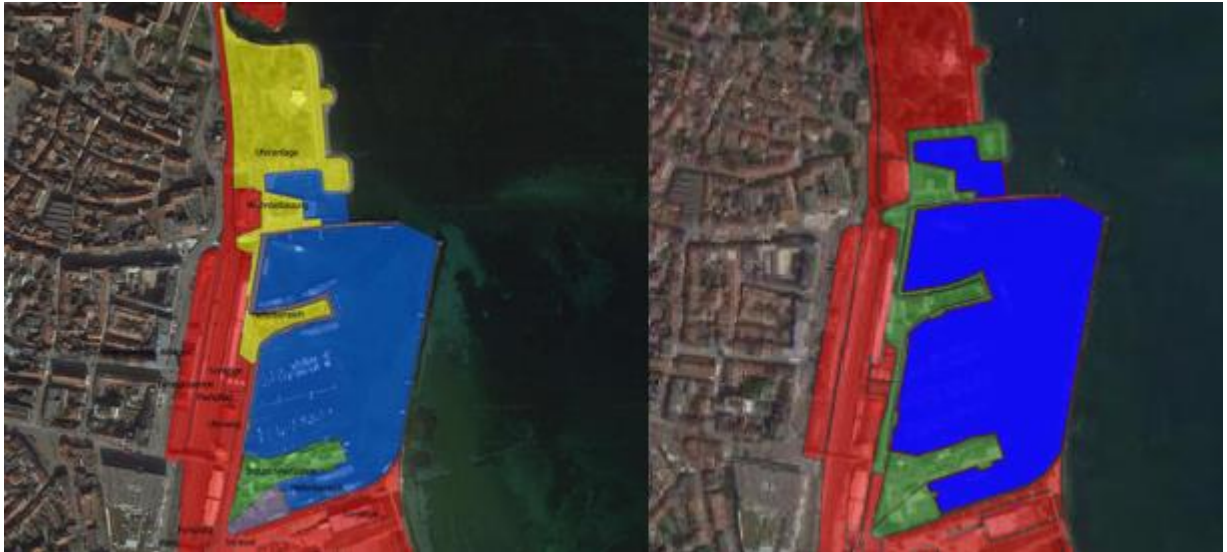
Abbildung 3: Beschneidung von Geometrien am Beispiel des Hafens Konstanz. Links im Bild eine als „Uferanlage“ sehr großflächig kartierte Geometrie (gelb), die im SuBoLakes-System jedoch nur teilweise eine den Hafen definierende Struktur darstellt (grün/blau). Um den Flächenfehler zu reduzieren, wurde die Geometrie geteilt und der nördliche Teil verworfen (rot). Hintergrund: Google Earth.
