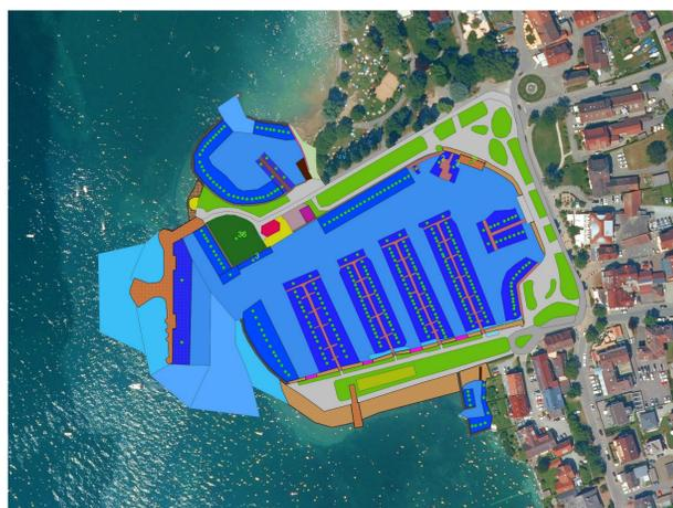
Fig. 5b : Hafen Unteruhldingen mit flächiger Darstellung der Struktur- und Ausstattungselemente (Blau – Wasserflächen, Punkte – Liegeplätze, Grün – Grün- u. Freiflächen).
