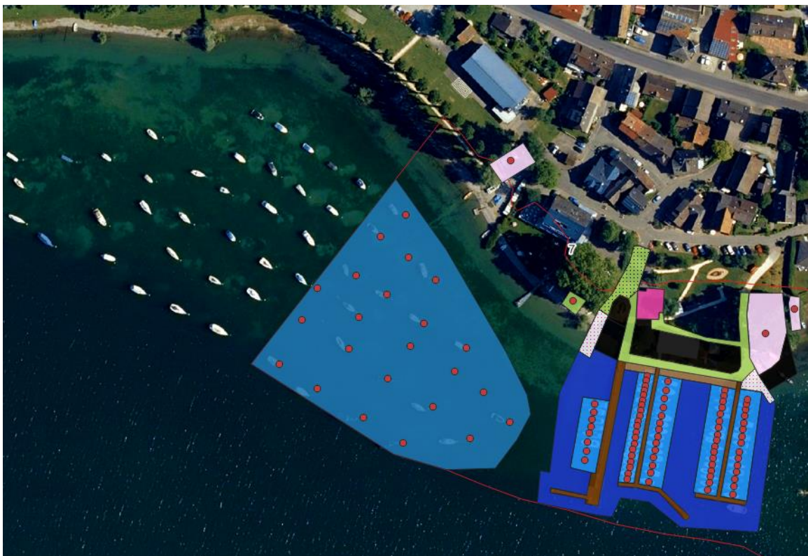
Abbildung 3: Beispiel für die uferenkrechte Zerschneidung eines Bojenfeldes (links, hellblau) entlang der Grenze der Stichprobenfläche (rote Linie). Der westliche Teil des Bojenfeldes bleibt unberücksichtigt, obwohl er Teil der IBK-Geometrie war. Rechts: Steganlage Wangen mit unterschiedlich eingefärbten Strukturelementen. Rote Punkte – Liegeplätze. Hintergrund: DOP20 des LGL BW.
